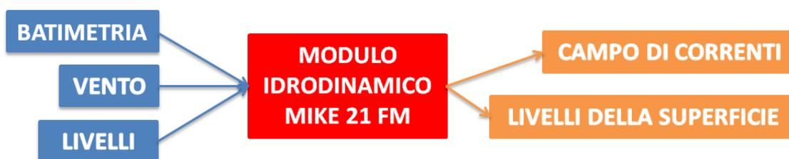
*Figura 43 - Diagramma illustrativo della modellistica numerica utilizzata*
