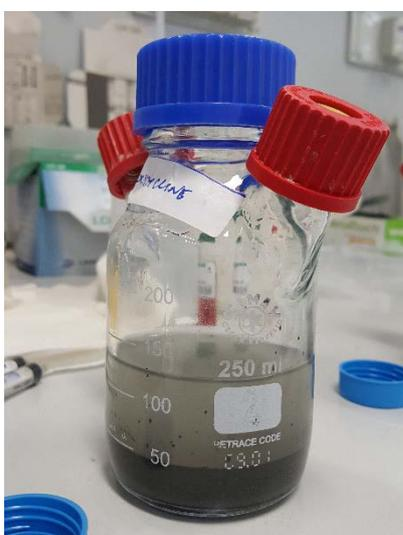
**Figura 30 – Bottiglia sigillata con all'interno sedimento e acqua della laguna.**
