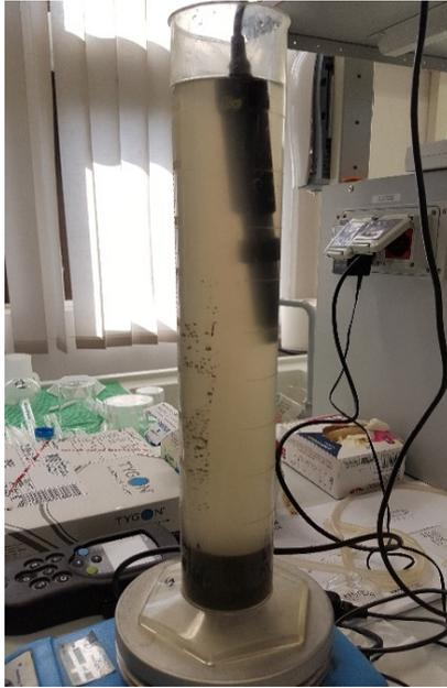
**Figura 38 – Test consumo ossigeno, senza miscelazione, con sonda non investita dal sedimento.**
