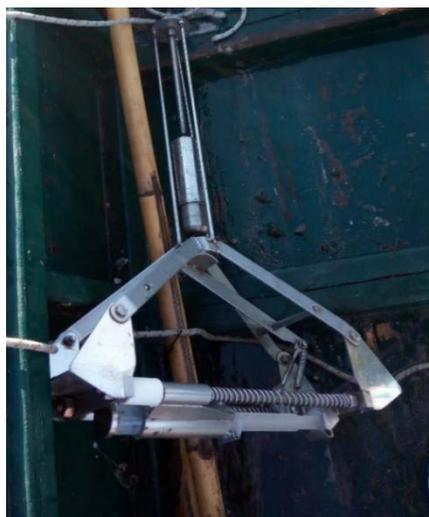
**Figura 32 – Campionatore utilizzato per la raccolta del sedimento.**
