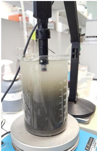
**Figura 39 – Test consumo ossigeno, con miscelazione, con sonda non investita dal sedimento.**
